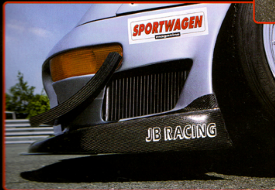
Le ventilateur, accouplé à l'un des échangeurs d'huile, se déclenche dès que la température de l'huile avoisine 90°C. Celui de gauche n'en dispose pas...
