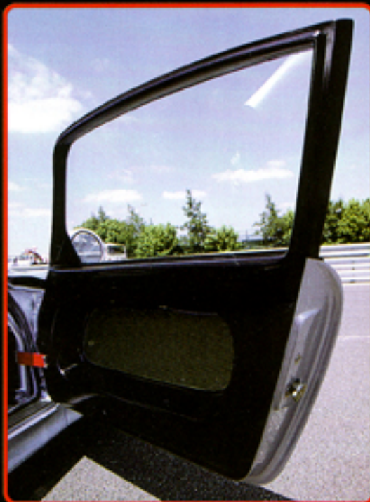
Les portes sont magnifiques; conçues d'une seule pièce, le cadre permet d'accueillir une vitre en Macrolon.
