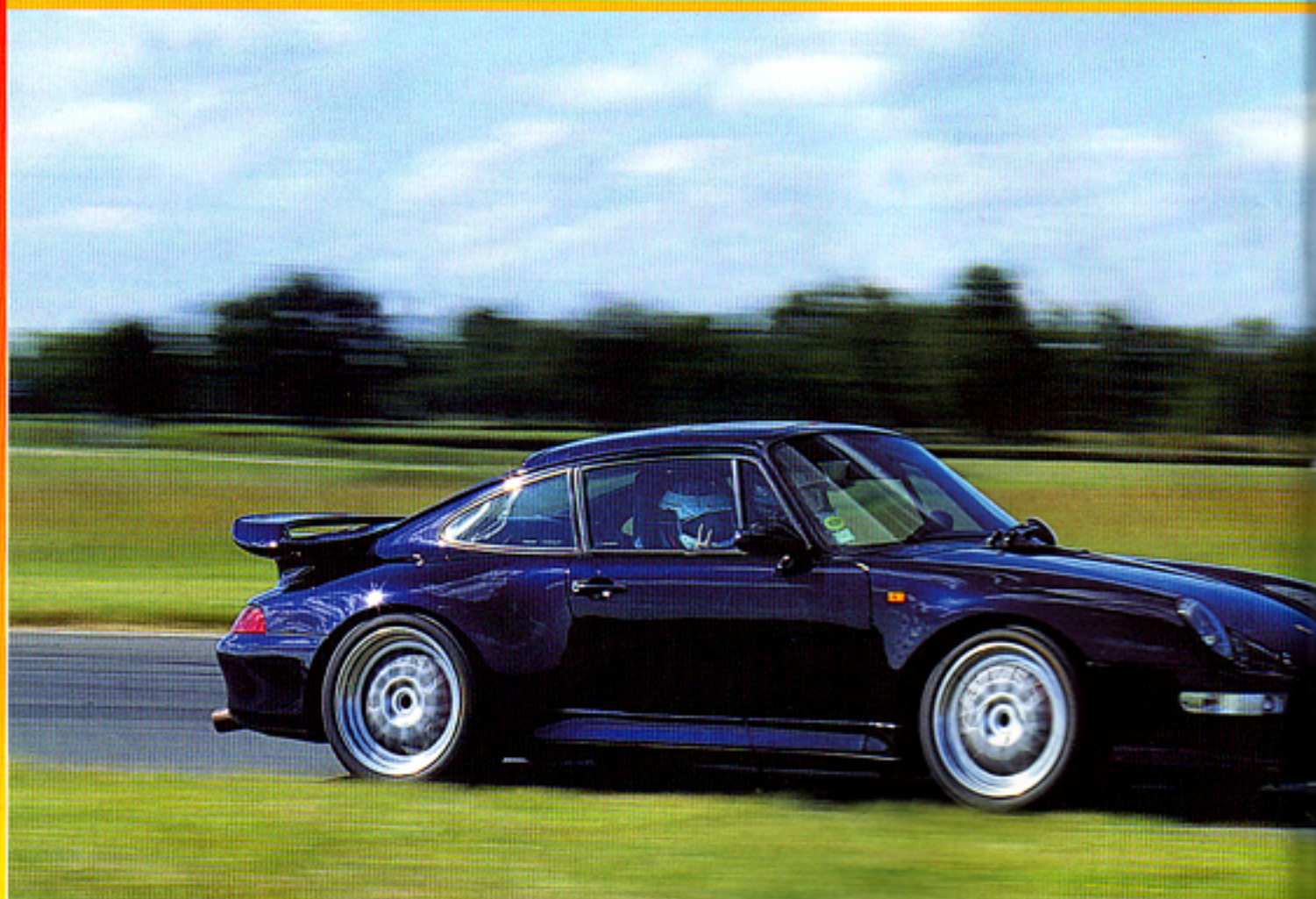
Les portes, les ailes et le capot sont en carbone afin de diminuer le poids. Après la modification, 1471 kg avec 70L d'essence et un pilote de 80 kg ont été mesurés, avec une répartition AR idéale de 431 kg sur chaque roue-AR et de 303/306 sur l'AV. Ce qui fait un petit 1400 kg en 4 RMA avec le plein. A noter que l'aile arrière et la lame de spoiler qui participent à la stabilité à haute vitesse sont issus du kit Porsche exclusive.
